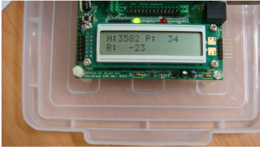
圖 4-19 LCD 顯示 Compass 資訊
